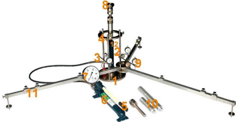
Rys. 1.1. Aparatura VSS z trzypunktowym pomiarem przemieszczenia płyty
