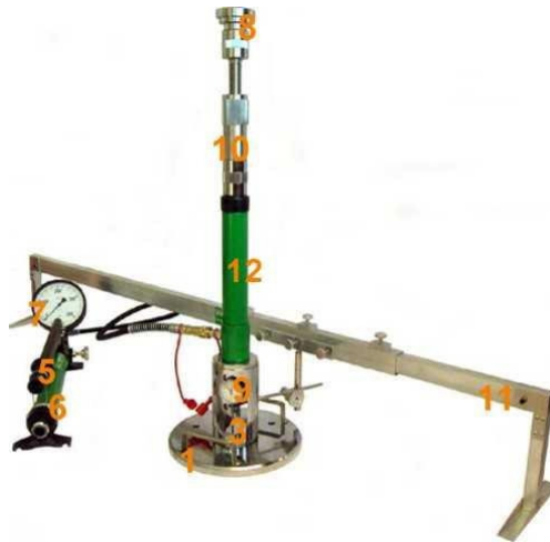
Rys. 1.2 Aparatura VSS z jednopunktowym pomiarem przemieszczenia płyty
