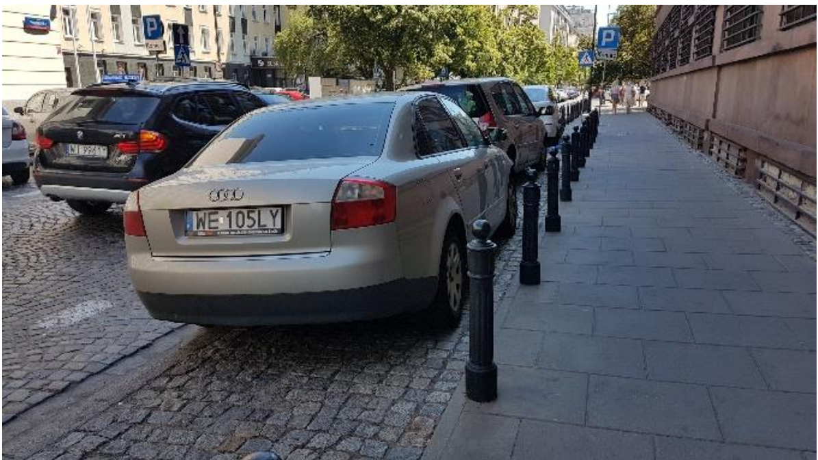
Rys. 8.2.6. Separacja pieszych od pojazdów parkujących na wyznaczonych miejscach parkingowych wzdłuż ulicy
