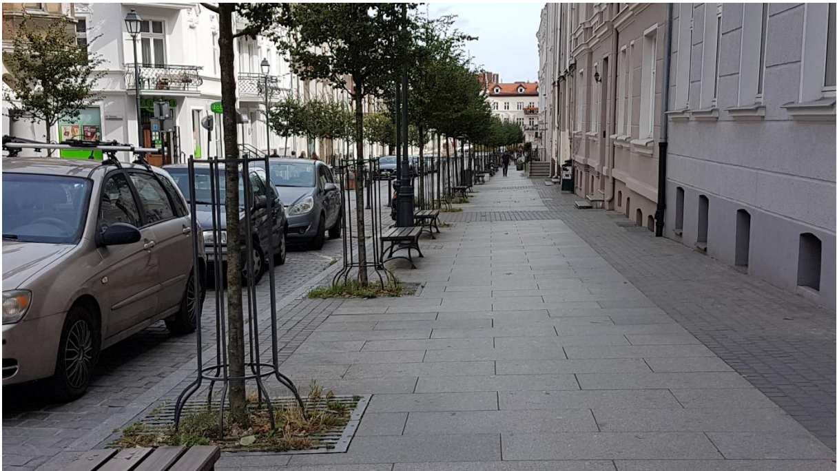
Rys. 7.2.9 Przykład usytuowania drogi dla pieszych przy krawędzi ulicy.
