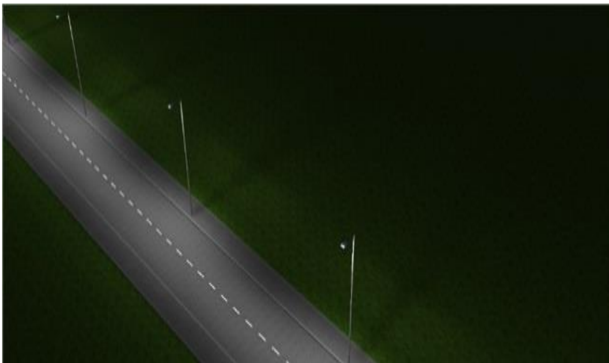
Rys. 15.1.1 Oświetlenie drogi dla pieszych – słupy zlokalizowane na chodniku przy jezdni
