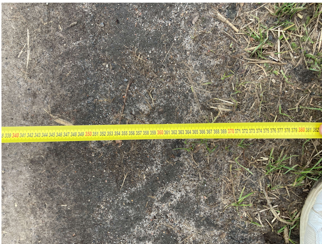
Fot. 6. Przykładowy pomiar szerokości istniejącej nawierzchni drogi
