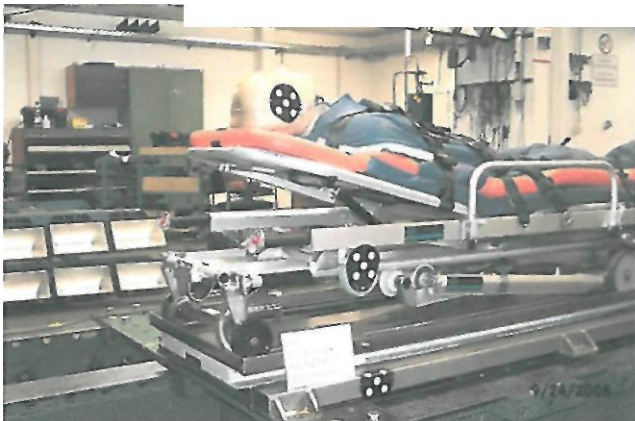
Szczegół: po stronie głowy; Wsporniki rurowe do mocowania podwozia na płycie ambulansu
