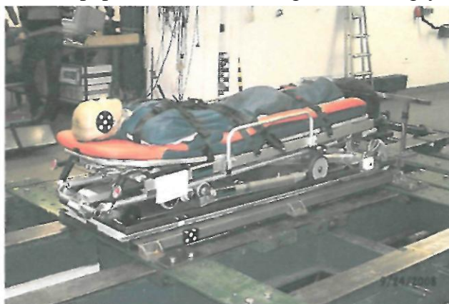
Próba w kierunku do przodu (po próbie)
