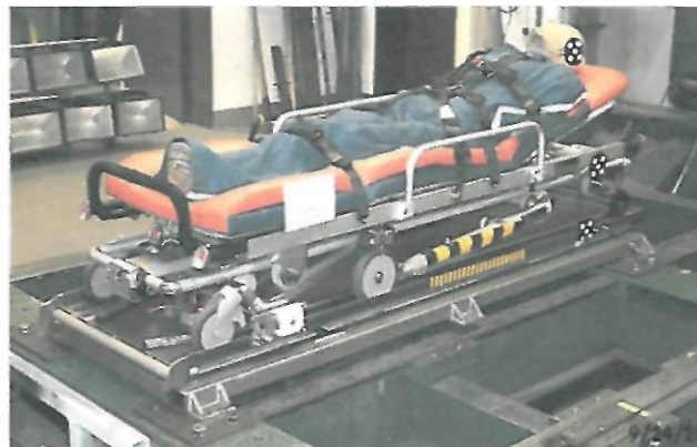
Próba w kierunku do przodu (przed próbą)
