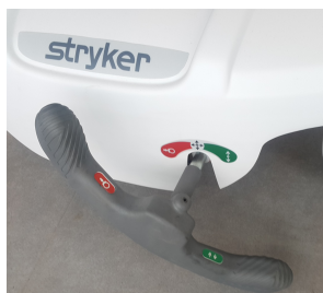
图 4 – 制动/转向踏板
