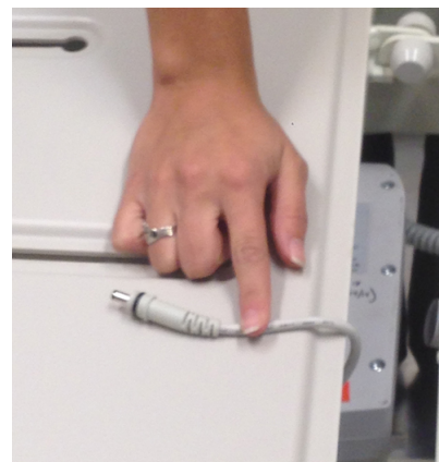
Abbildung 5-5: Ausstecken des Batteriekabels vom Steuerungskasten
