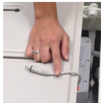
Figur 12-5: Batterikabeln kopplas bort från kontrollboxen
