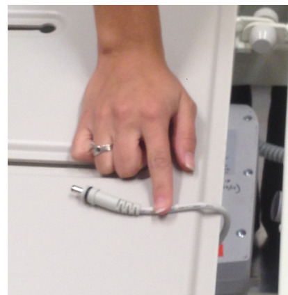
Figura 4-5: Scollegamento del cavo della batteria dalla centralina di comando
