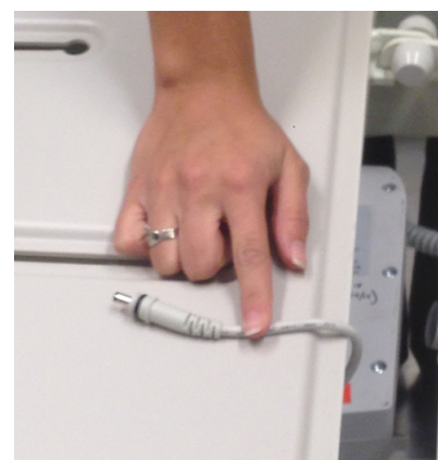
Slika 17-5: Iskapćanje kabela baterije iz upravljačke kutije
