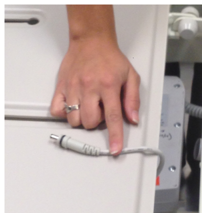
Afbeelding 8-5: De accukabel loskoppelen van het regelkastje
