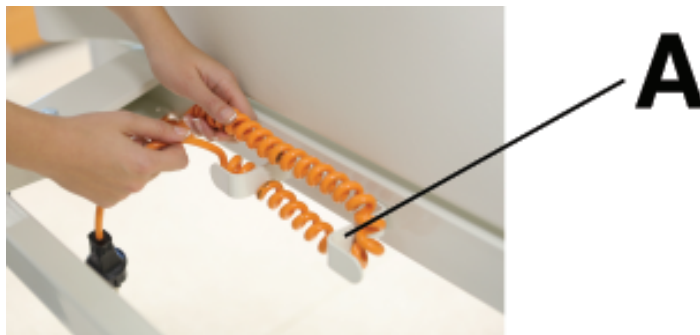
Obrázok 18-6: Skladovanie napájacej šnúry
