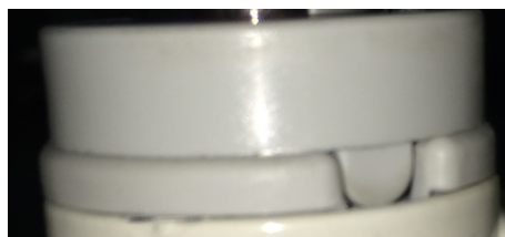
Obrázek 15-23: Uzamčení IV stojanu
