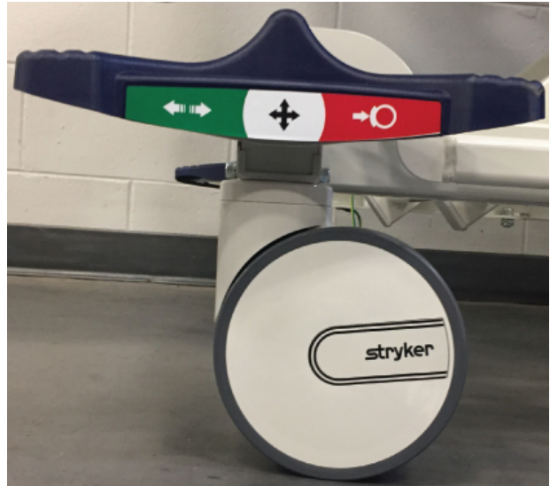
Kuva 11-12: Viidennen pyörän vapauttaminen
