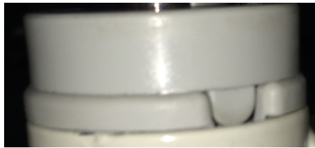
Figura 16-28: Blocarea suportului pentru butelia cu oxigen
