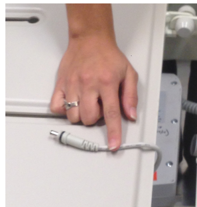
Obrázok 18-5: Odpojenie kábla batérie z ovládacej skrinky
