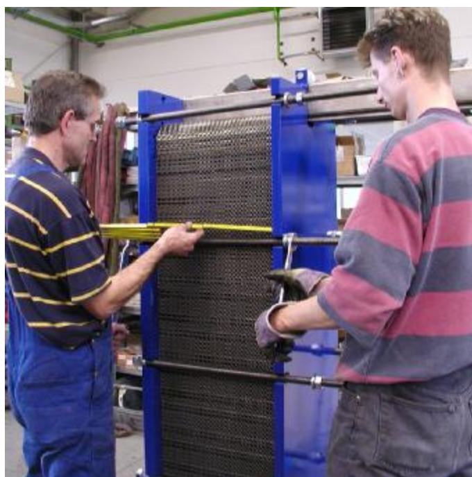
Ilustracja 10/2: Prawidłowe otwarcie płytowego wymiennika ciepła (PWT) z kontrolą dozwolonego położenia poprzecznego płyty zdejmowanej.
