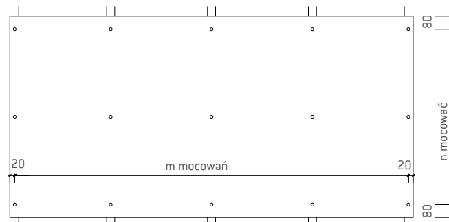
poziome rozmieszczenie płyt
