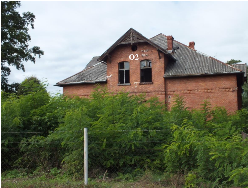
Pastorówka, ul. Bursztynowa, elewacja wschodnia z zaznaczonym usytuowaniem stolarek przeznaczonych do wymiany
