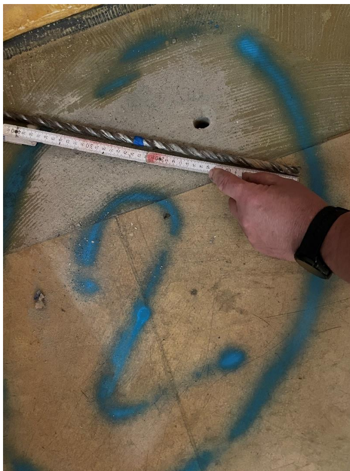
Rysunek 4-5. Odkrywka 2. Sprawdzenie grubości stropu.
