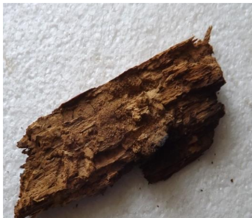
Próbka z podwaliny
