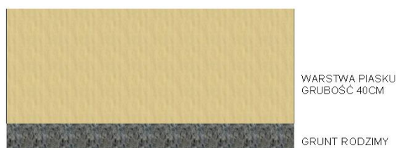
Rys. Przekrój przez nawierzchnię piaszczystą
