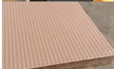
Platformy oraz ścianka wspinaczkowa z antypoślizgowego HPL o grubości minimum 12,5mm.
