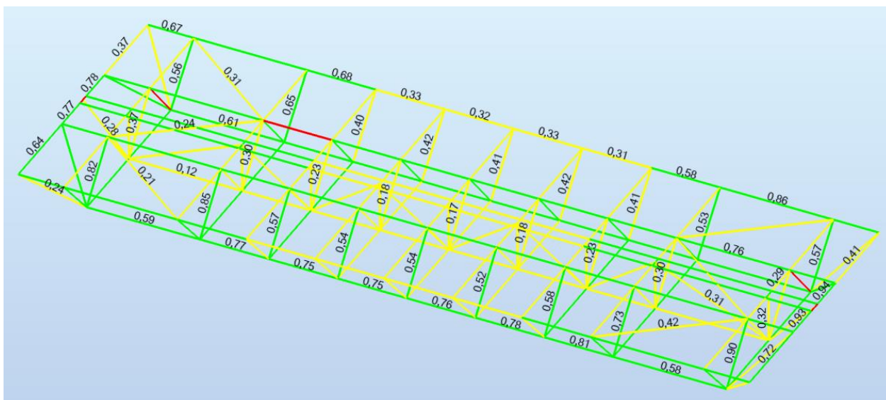
Rysunek 23 Wytężenie elementów drewnianych zadaszenia nad wiatą strzelnicy
