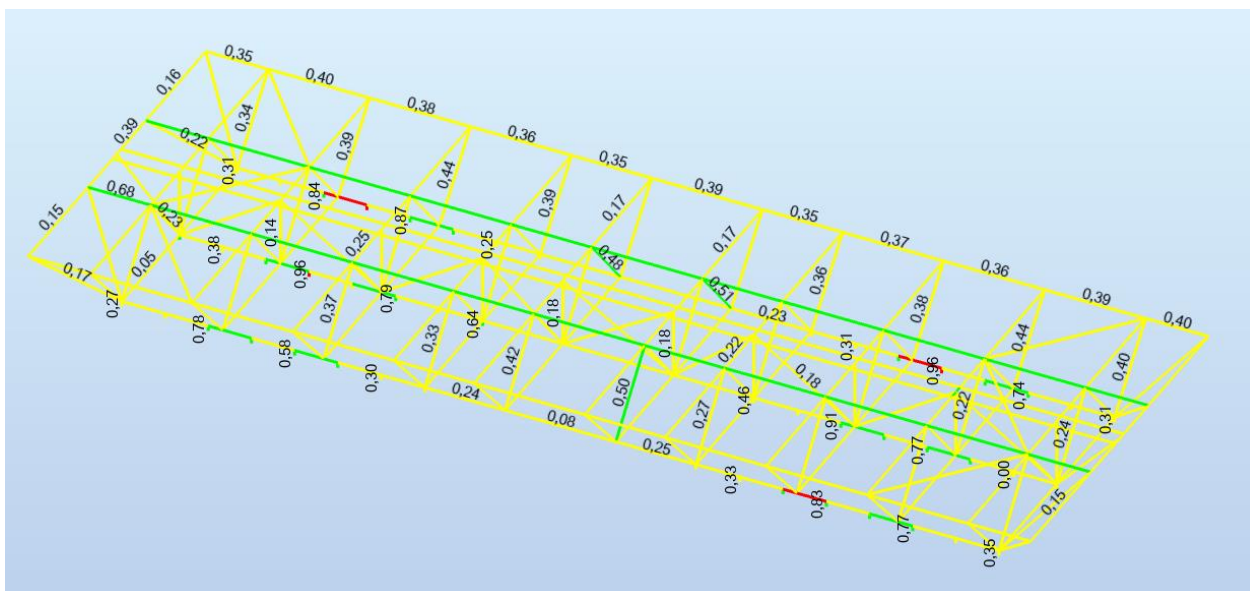
Rysunek 22 Wytężenie elementów drewnianych zadaszenia nad budynkiem socjalnym
