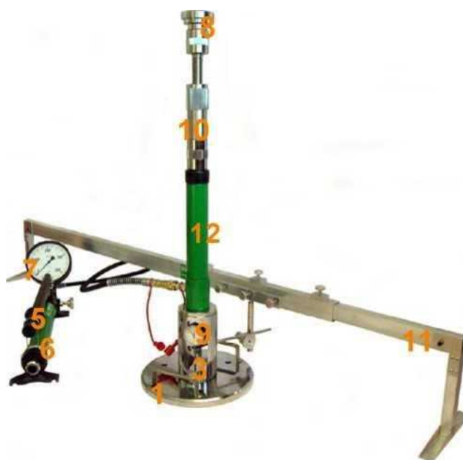
Rys. 1.1. Aparatura VSS z trzypunktowym pomiarem przemieszczenia płyty
