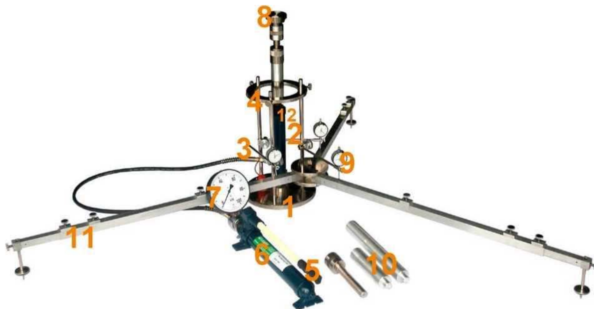
Rys. 1.1. Aparatura VSS z trzypunktowym pomiarem przemieszczenia płyty
