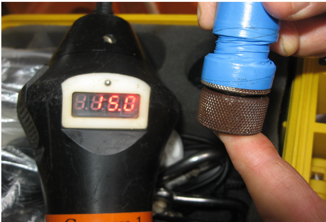
Kalibracja urządzenia pomiarowego Cygnus do pomiaru grubości stalowych ścianek szczelnych
