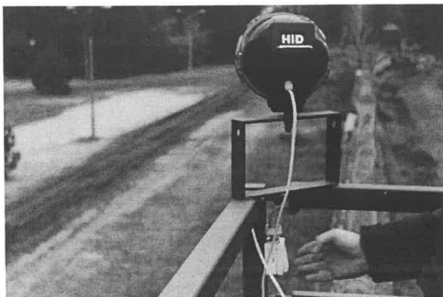
Przykładowy niewłaściwy montaż przewodów instalacyjnych
