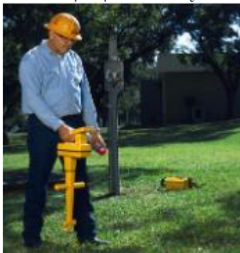
Rys. 40. Lokalizowanie i pomiar głębokości znaczników elektromagnetycznych
