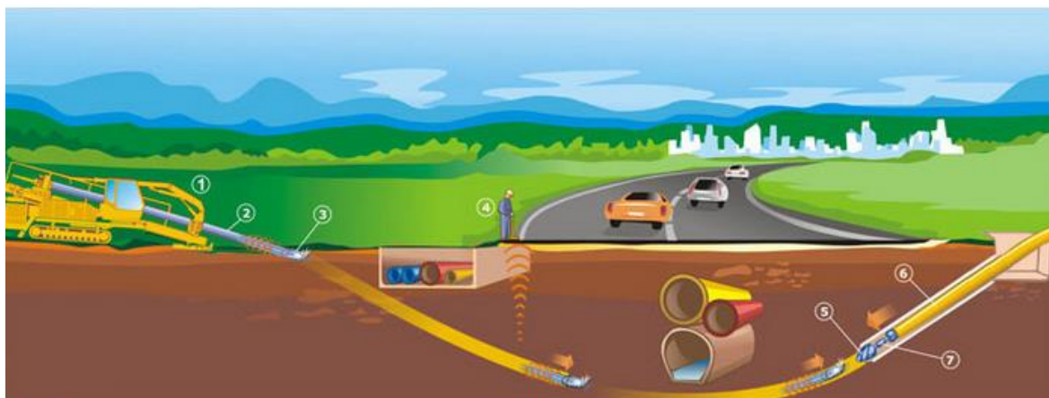
Rys. 29. Wykonywanie otworów pod kanalizację kablową metodą przewiertu
