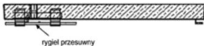
Rys. 7. Pokrywa z rygłem przesuwany
