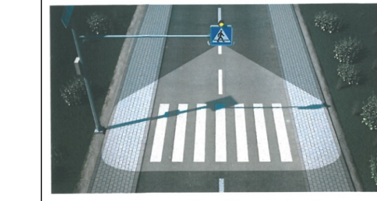
Wyniesione przejścia dla pieszych z aktywnym oznakowaniem na wysięgniku w postaci światła pulsującego barwy pomarańczowej wzbudzanego przez pieszego zbliżającego się do przejścia. Oświetlenie zasilane panelami fotowoltaicznymi.
