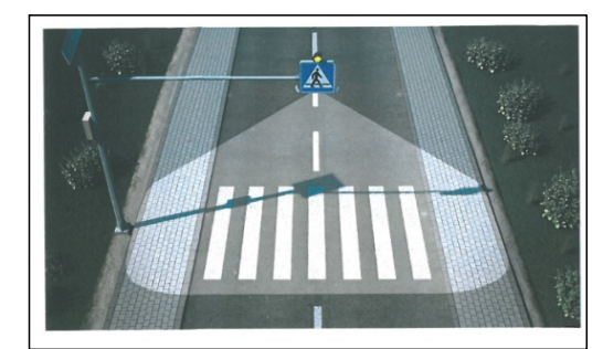
Wyniesione przejścia dla pieszych z aktywnym oznakowaniem na wysięgniku w postaci światła pulsującego barwy pomarańczowej wzbudzanego przez pieszego zbliżającego się do przejścia. Oświetlenie zasilane panelami fotowoltaicznymi.
