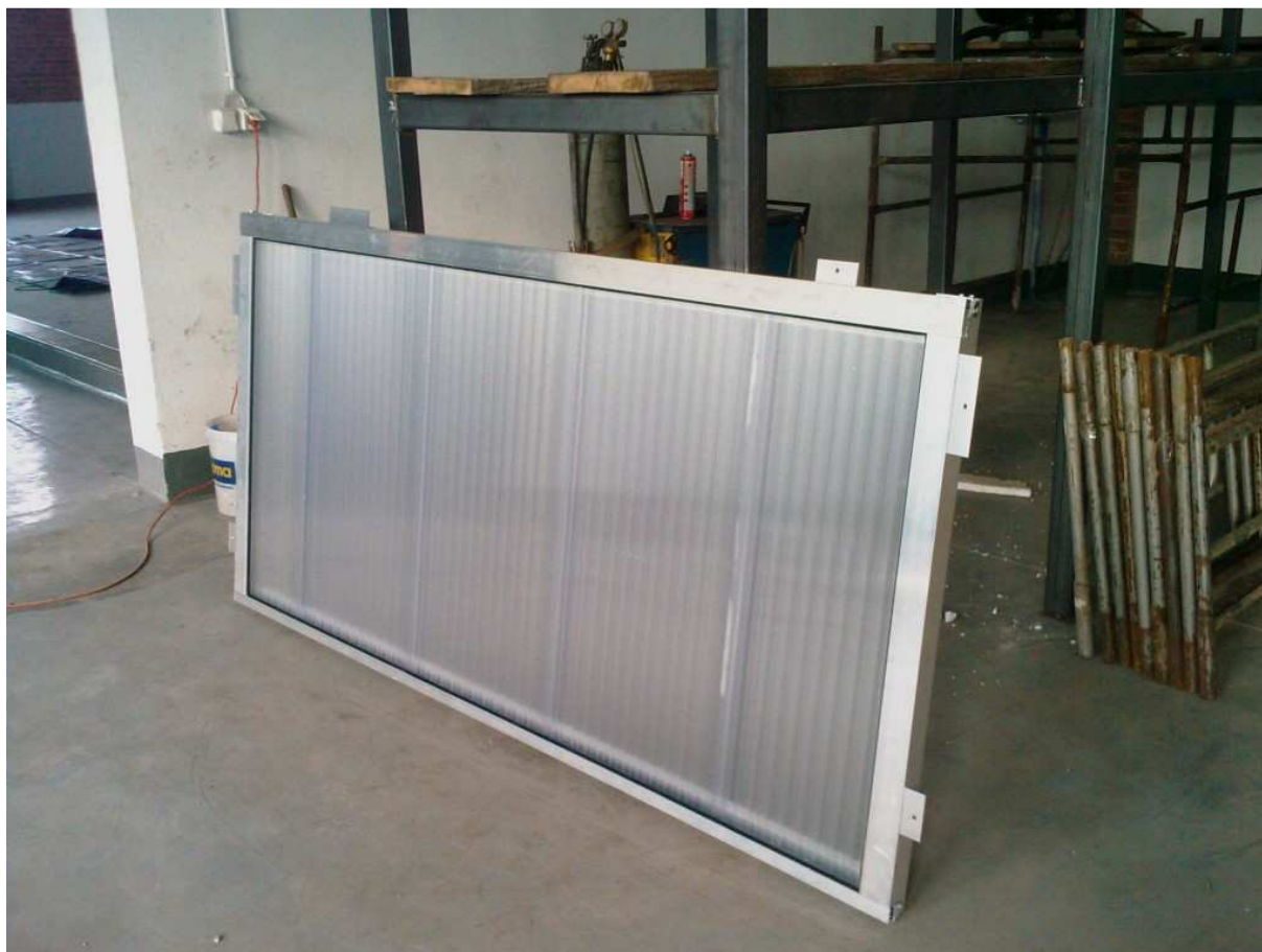
Fot.3. Poglądowy widok na ramkę wypełnioną poliwęglanem litym.
