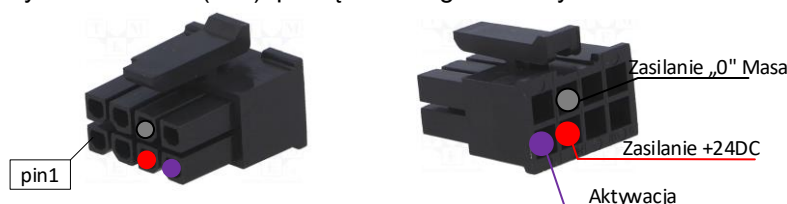
Rysunek 30 Wtyk Molex - zasilanie kasownika
