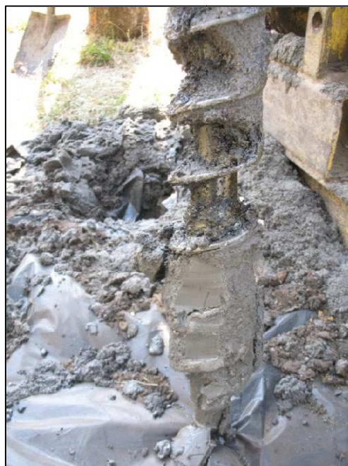
Ryc. 6. Widok z dwóch ujęć miejsca pobrania próbki Bdg 2/6,5 – piaski gruboziarniste przesycone olejami mineralnymi i WWA tuż nad stropem szarych ilów.
