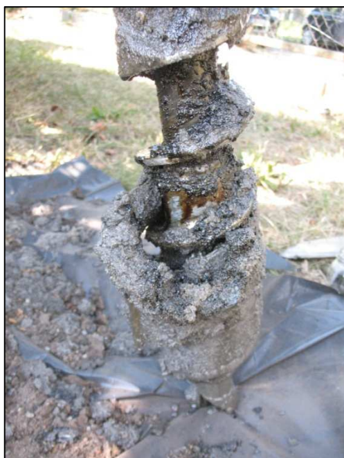
Ryc. 6. Widok z dwóch ujęć miejsca pobrania próbki Bdg 2/6,5 – piaski gruboziarniste przesycone olejami mineralnymi i WWA tuż nad stropem szarych ilów.
