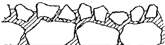
Rys. 3. Schematyczny obraz powierzchniowego utrwalenia nawierzchni typu „sandwich”
