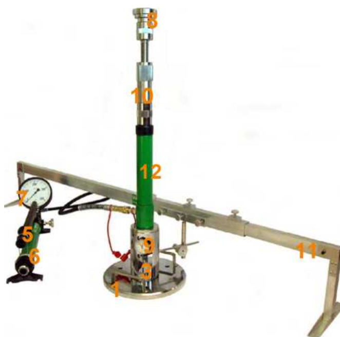
Rys. 1.2 Aparatura VSS z jednopunktowym pomiarem przemieszczenia płyty
