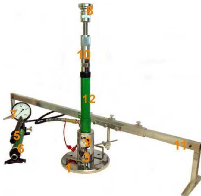
Rys. 1.2 Aparatura VSS z jednopunktowym pomiarem przemieszczenia płyty
