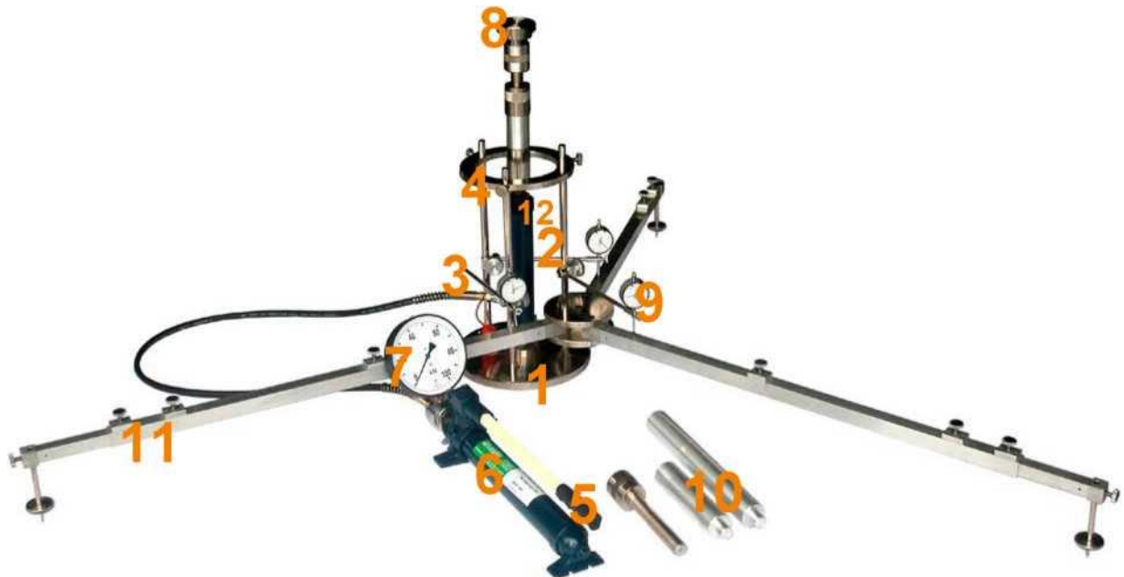
Rys. 1.1. Aparatura VSS z trzypunktowym pomiarem przemieszczenia płyty
