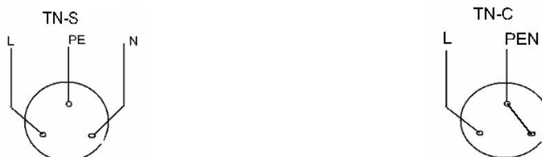
Rys 1. Schemat przyłączenia przewodów do gniazda wtyczkowego ze stykiem ochronnym w układzie sieci TN-S i TN-C
