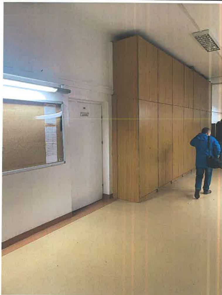
Rys.1. Szafki z materiałów drewnopochodnych bez potwierdzonej klasy reakcji na ogień przeznaczone do składowania materiałów palnych
