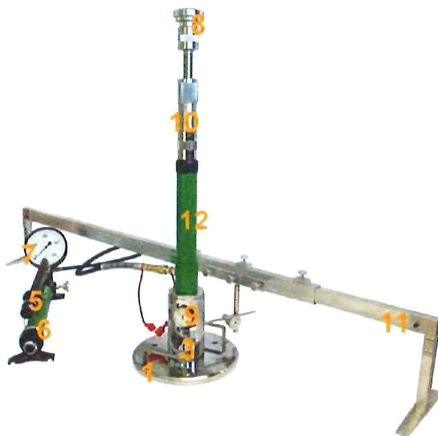
Rys. 1.2 Aparatura VSS z jednopunktowym pomiarem przemieszczenia płyty
