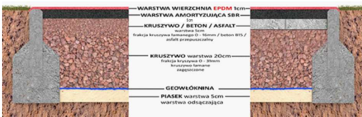
Szczegółowy układ warstw nawierzchni bezpiecznej
