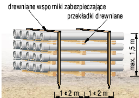
Rys. Składowanie rur na placu budowy
