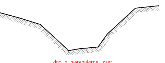
SZCZEGÓŁ NR 7 PRZESZCZĄT ISTNIEJĄCYCH RÓWÓW PO ODMULENIU
