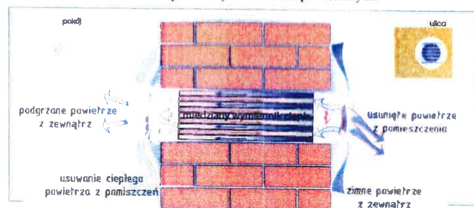
Rys. 1. Zasady działania rekuperatora PRANA-150, PRANA-200.
