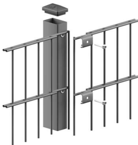
Rys. 3 Montaż ogrodzenia siłowni zewnętrznej
