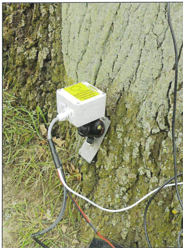
Zdj. 8. Czujnik podczas badania obciążeniowego
