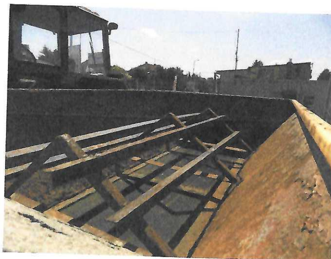
widok podzespołów rozsiewacza - postępujący proces korozji
