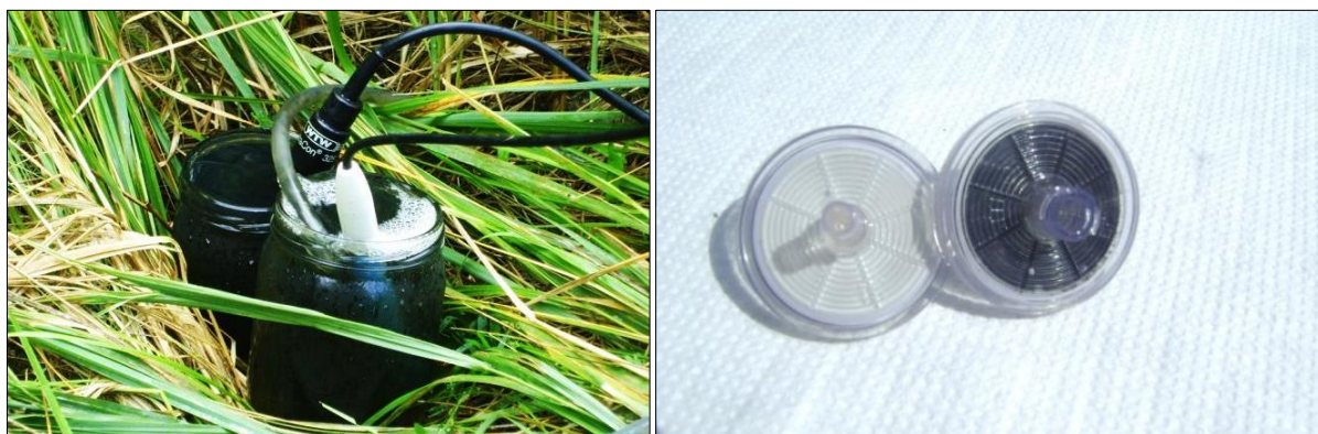
Fot. 4. Silnie zanieczyszczona woda podziemna oraz filtr 0,45 \mu\text{m} przed i po filtracji wody (fot. D. Pietrucin)
