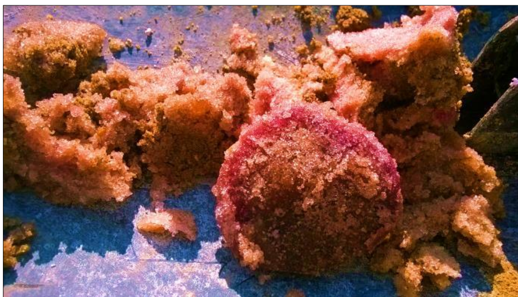
Fot. 6. Zrekrytalizowany siarczyn sodowy silnie zanieczyszczony fenolem (fot. D. Pietrucin)
