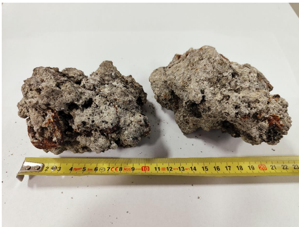
Rysunek 2.9 Przykładowe zdjęcie żużli występujących w formie spieków - przykład nr 1
