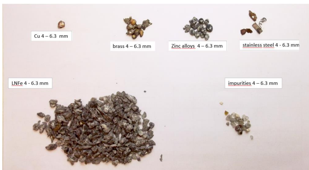
Rysunek 2.6 Przykłady form występowania metali o frakcji 4 – 6,3 mm.
