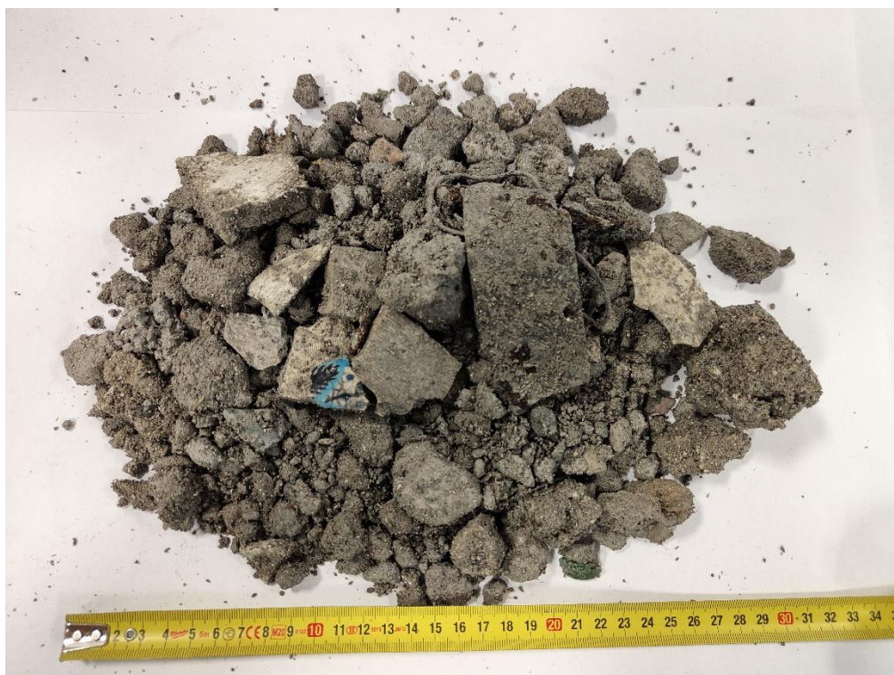
Rysunek 2.12 Przykładowe zdjęcie żużli występujących w formie spieków - przykład nr 4
