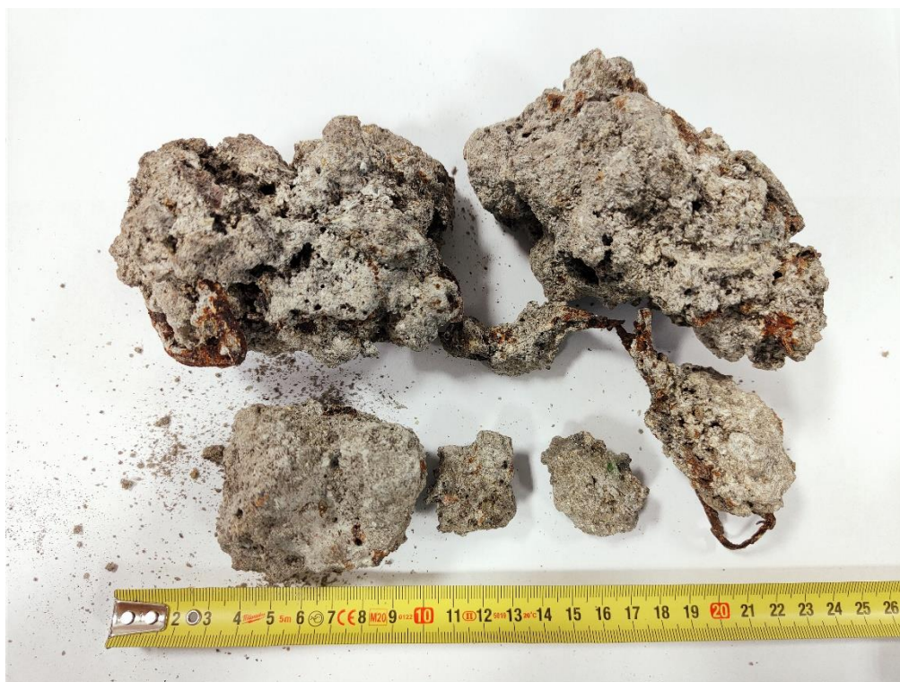
Rysunek 2.10 Przykładowe zdjęcie żużli występujących w formie spieków - przykład nr 2
