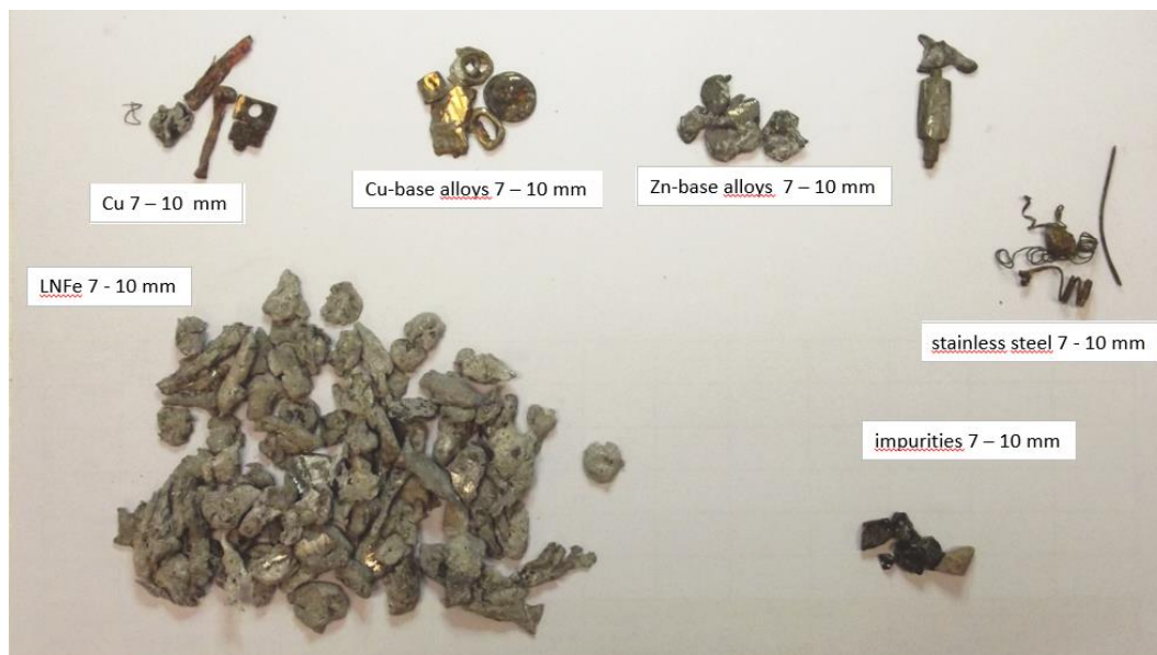
Rysunek 2.5 Przykłady form występowania metali o frakcji 7 – 10 mm.
