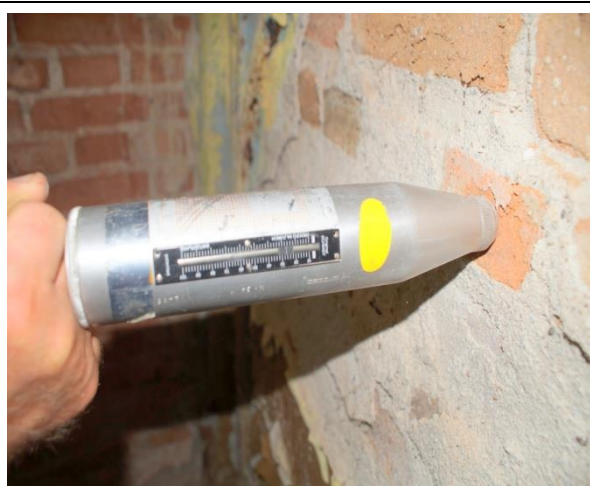
Zd. 6.27. Badanie wytrzymałości na ściskanie murów w zakresie cegły ceramicznej pełnej
