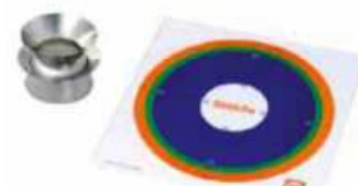
Narzędzie do przeprowadzania prób rozplywu jastrychu
