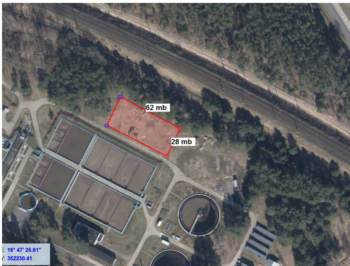
Rys. 1 Wydzielone miejsce do montażu elektrowni fotowoltaicznej.
