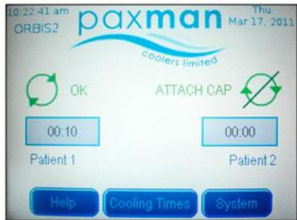
Rysunek 24. Symbol gotowości urządzenia do pracy w przypadku, kiedy z urządzenia korzysta tylko jeden pacjent.
