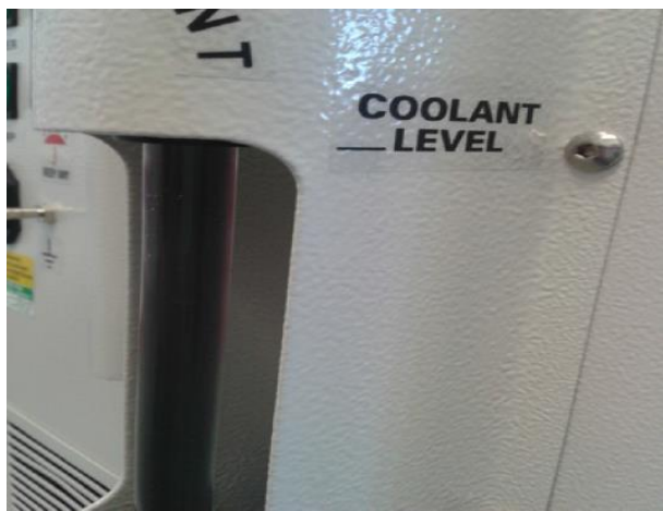
Rysunek 17. Oznaczenie prawidłowego poziomu chłodziwa w urządzeniu.
