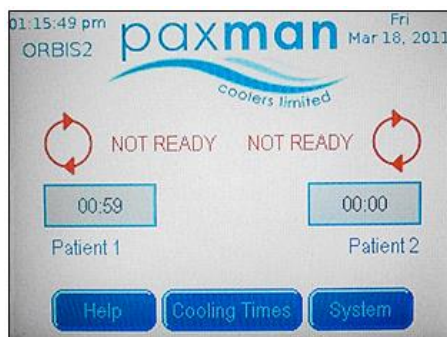
Rysunek 2. Symbol statusu „NOT READY” – temperatura płynu wyższa o 5°C od zadanej wartości temperatury.
