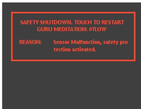
Rysunek 4. Ekran ostrzegawczy w przypadku wystąpienia problemu z czujnikiem temperatury.
