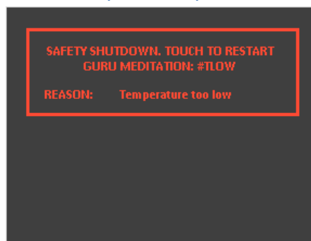
Rysunek 3. Ekran ostrzegawczy w przypadku osiągnięcia zbyt niskiej temperatury płynu.
