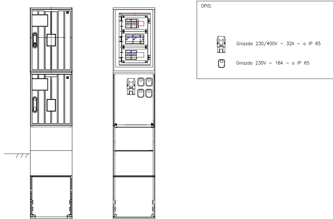
WIDOK I ROZMIESZCZENIE APARATURY (ZŁĄCZE WOLNOSTOJĄCE - ZR1) na fundamencie
