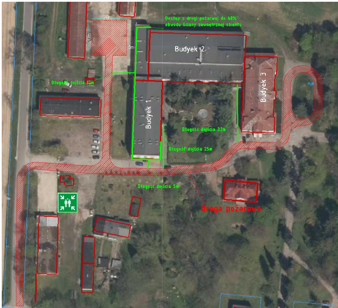
Fot.4 Doprowadzenie drogi pożarowej do obiektu
