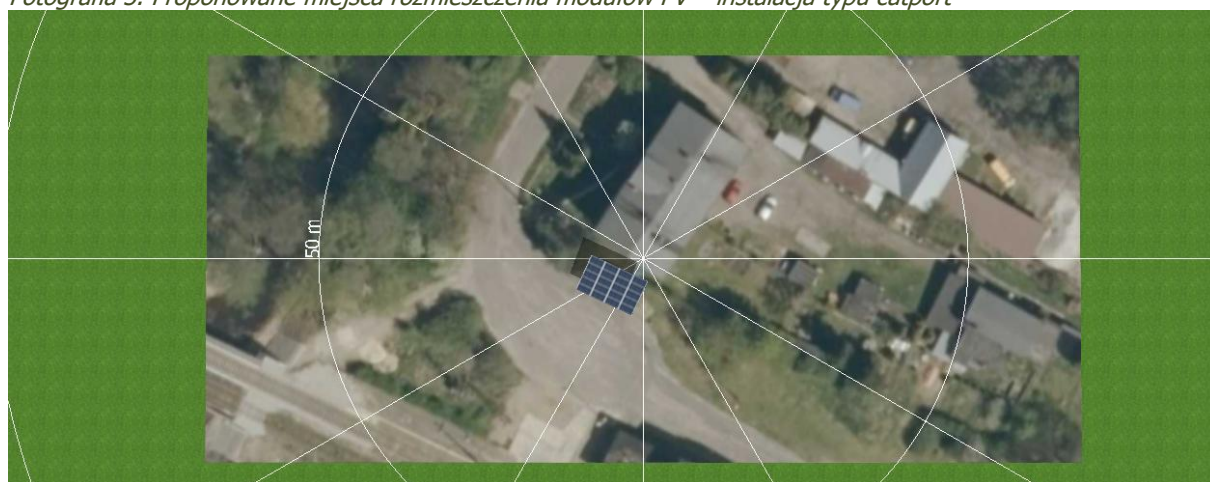
Fotografia 3. Proponowane miejsca rozmieszczenia modułów PV – instalacja typu catport
