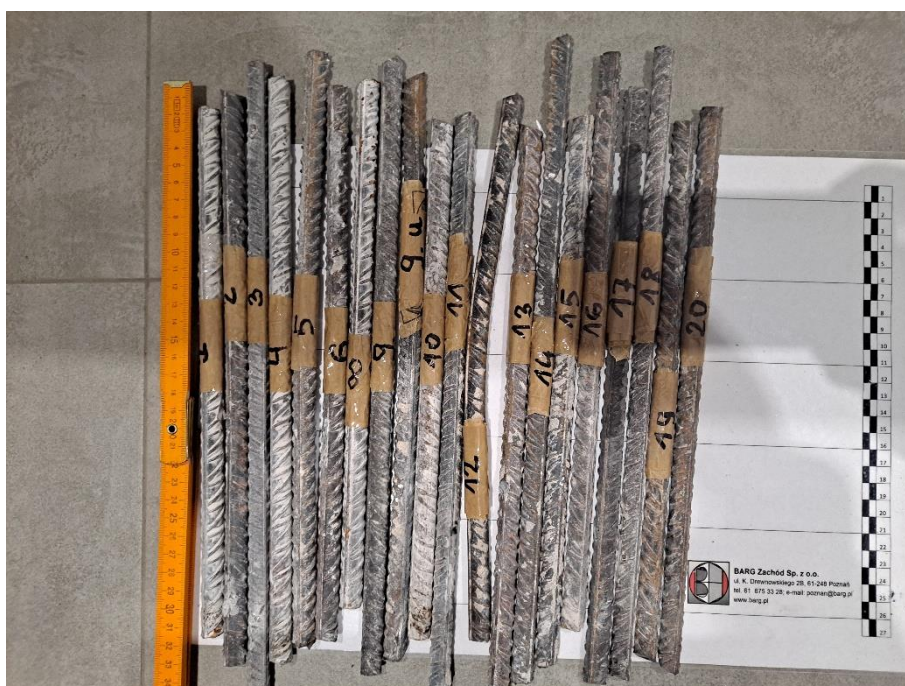
Fot. 4.5 Pobrane fragmenty zbrojenia przeznaczone do badań wytrzymałości na rozciąganie
