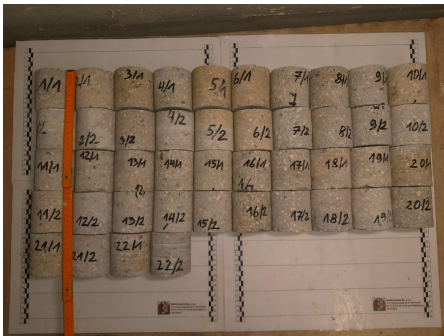
Fot. 4.4 Próbki rdzeniowe przygotowane do badań wytrzymałościowych
