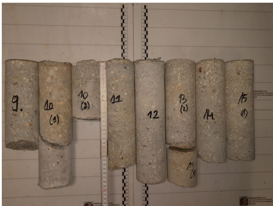
Fot. 4.2 Odwierty rdzeniowe pobrane z konstrukcji ścian – punkty nr 9-15
