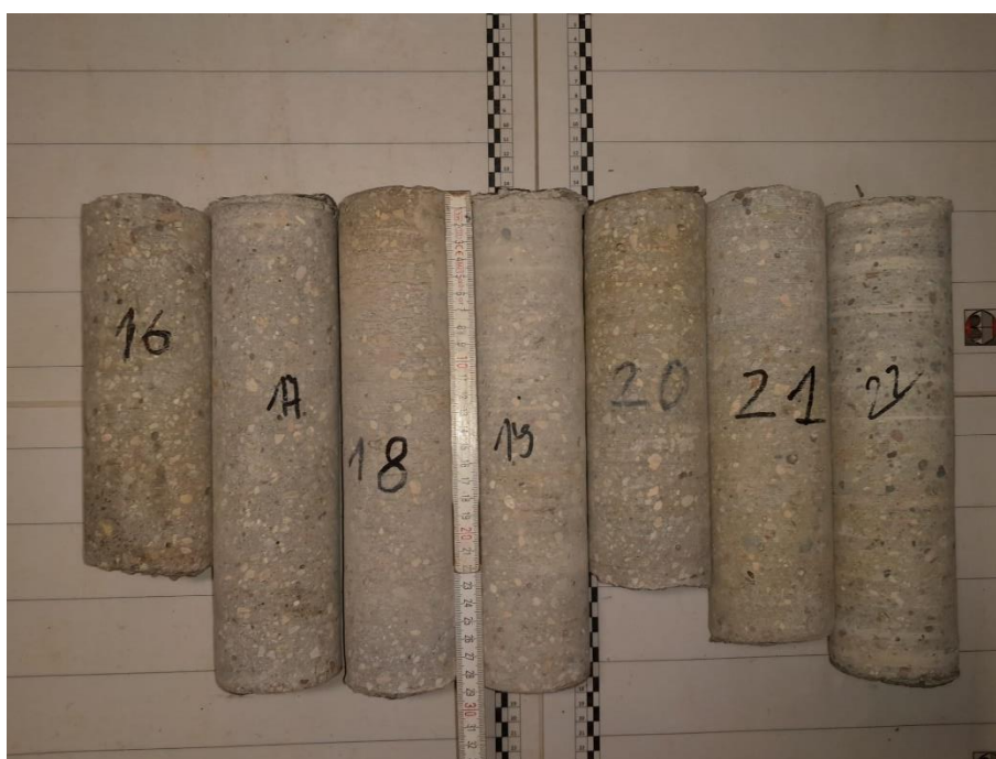
Fot. 4.3 Odwierty rdzeniowe pobrane z konstrukcji ścian – punkty nr 16-22
