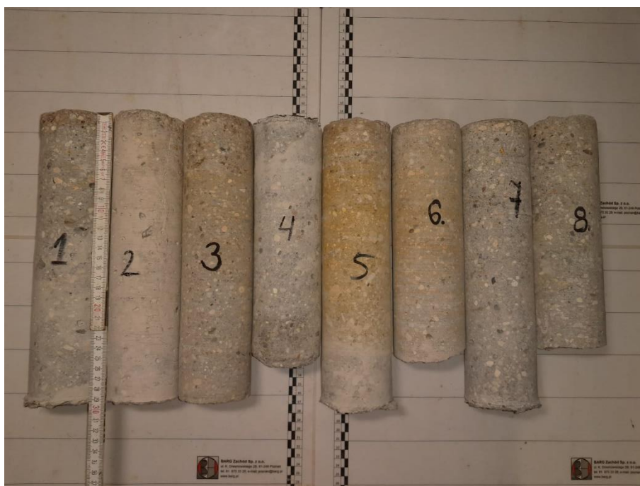
Fot. 4.1 Odwierty rdzeniowe pobrane z konstrukcji ścian – punkty nr 1-8
